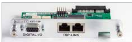
KTTI-TSP – интерфейс TSP-Link с 6 цифровыми портами ввода-вывода.
