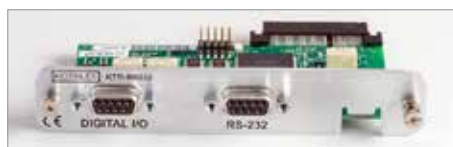
KTTI-RS232 – интерфейс RS-232 с 6 цифровыми портами ввода-вывода.
