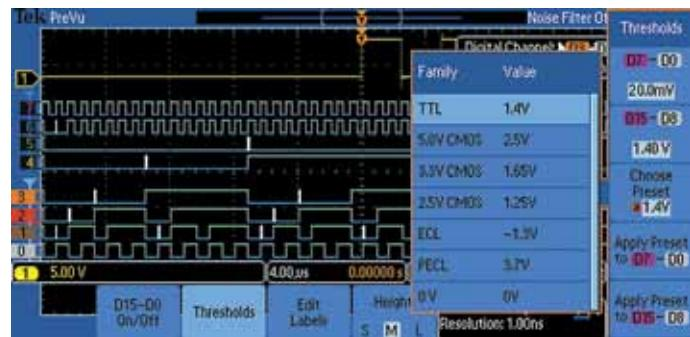
Цветовое кодирование цифровых сигналов позволяет объединять их в группы, просто располагая на экране рядом друг с другом. Затем помеченные цифровые каналы можно перемещать единой группой. Для каждой группы из восьми каналов можно установить отдельные пороги, что обеспечивает поддержку логических устройств двух разных типов.
