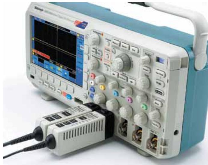
Интерфейс TekVPI упрощает подключение пробников к осциллографу.
