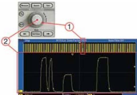
Панель управления Wave Inspector обеспечивает непревзойденную эффективность просмотра, навигации и анализа данных. Поворотом внешней ручки панорамирования можно пролистать весь 1 млн. точек записи (1). Перемещение из начала в конец займет считанные секунды. А если вы увидели нечто интересное и хотите подробнее это рассмотреть? Просто поверните внутреннюю ручку масштабирования (2).
