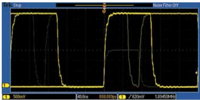
Обнаружение: высокая скорость захвата сигнала – более 5000 осциллографов в секунду – максимально повышает вероятность обнаружения кратковременных глитчей и других редко происходящих событий.
