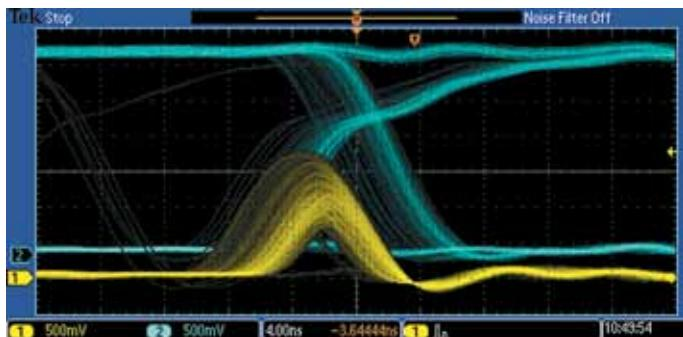
Технология цифрового люминофора осциллографов MSO/DPO2000B поддерживает скорость захвата более 5000 осциллограмм в секунду и отображение градаций яркости в реальном времени.
