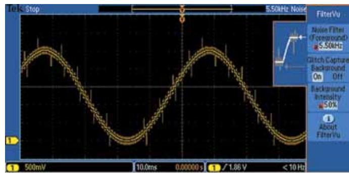
Выходной сигнал ЦАП – обратите внимание, как четко FilterVu™ выявляет на основной осциллограмме (желтой) свободные от шума ступеньки сигнала ЦАП, из которого были удалены все частоты выше 5,5 кГц. На фоновой осциллограмме (оранжевой) видны высокочастотные глитчи, которые FilterVu позволяет захватывать в полной полосе пропускания осциллографа.
