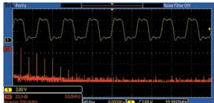
Анализ: быстрое преобразование Фурье импульсных сигналов. Всеобъемлющий набор встроенных средств анализа ускоряет проверку характеристик схемы.
