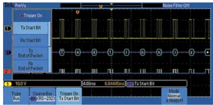
Захват: запуск по конкретному пакету данных, передаваемому по шине RS-232. Полный набор функций запуска, включая запуск по содержимому пакета последовательных данных, позволяет быстро захватывать интересующее событие.
