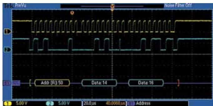
Запуск по конкретному пакету данных, проходящему по шине I<sup>2</sup>C. Желтая осциллограмма представляет собой сигнал тактовой частоты, а синяя – данные. Осциллограмма сигнала шины показывает декодированное содержимое пакета, включая Старт, Адрес, Чтение/Запись, Данные и Стоп.
