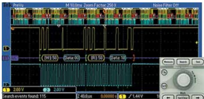
Поиск: функция декодирования шины I<sup>2</sup>C, показывающая результаты поиска адреса 50. Панель управления Wave Inspector обеспечивает непревзойденную эффективность просмотра и навигации.
